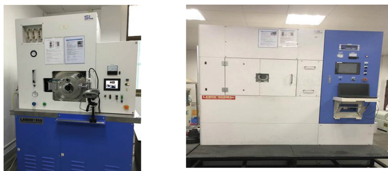
图3 放电等离子烧结系统LABOX-350、LABOX-6020K
